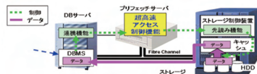
図 2 クエリプラン利用先読み技術プロトタイプの構成概略
