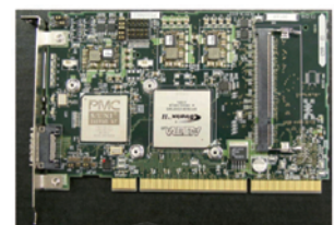
図 3 故障模擬装置付 10Gbps ネットワークカード
