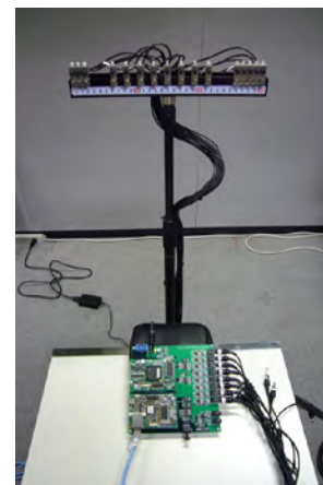
図 マイクロフォンアレー及び SSA 用実時間 DSP モジュール
