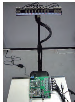
図4：マイクロフォンアレイ及び SSA 用実時間 DSP モジュール
